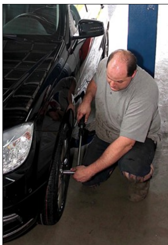
"Het aanspannen van de moeren volgens de juiste aanhaalmomenten is uiterst belangrijk."
